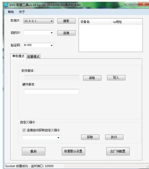
1. 设置本电脑的 IP 为 10 网段的 IP，子网掩码 255.0.0.0，打开软件，本地 IP 选择本机 IP。
